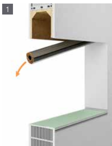
Alten Rollladen aus Kasten entfernen!
